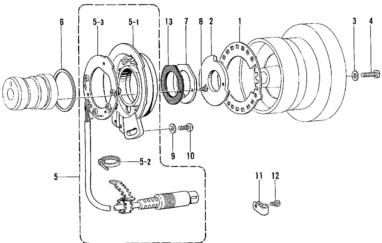
S. 踏板関係 / Foot switch pedal mechanism/Fußbetätigungs/
