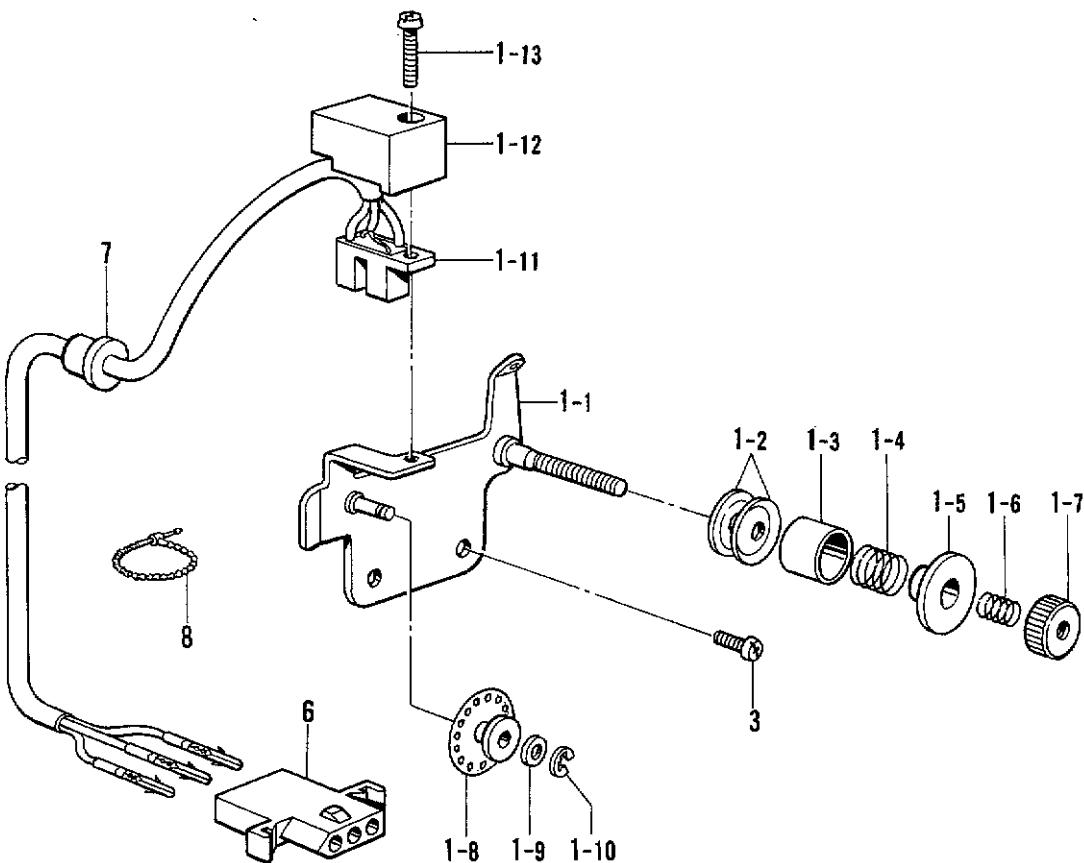
N. 糸拭イ関係 / Thread wiper mechanism / Fadenwischvorrichtung /
